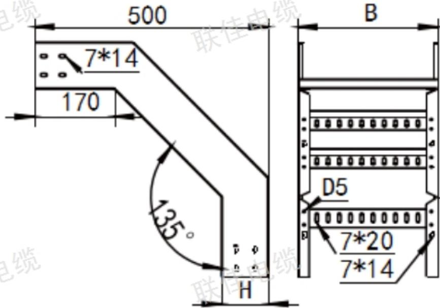
镀锌梯式线槽条件有很强的牢固性能，并且它的耐磨性也有很强的牢固性能。锌这种金属本身就是具有非常好的隐身性能和可塑性的，所以把新加在梯式线槽中进行使用可以很大程度的加强，线槽的可塑性是热度件再进行拉伸和弯曲，等等这些成型操作的时候不会损坏镀层。梯式线槽在，建筑业发展迅速，在许多地方都可以看到建筑工地，电气工程非常重要。桥梁的发展也得到了促进，在现实中的应用越来越频繁，为人们的生产生活带来的帮助。但是，由于其用途普遍，还存在很多问题，例如腐蚀问题。
